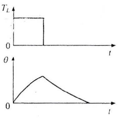
Fig. 5.3. Motor load diagram
